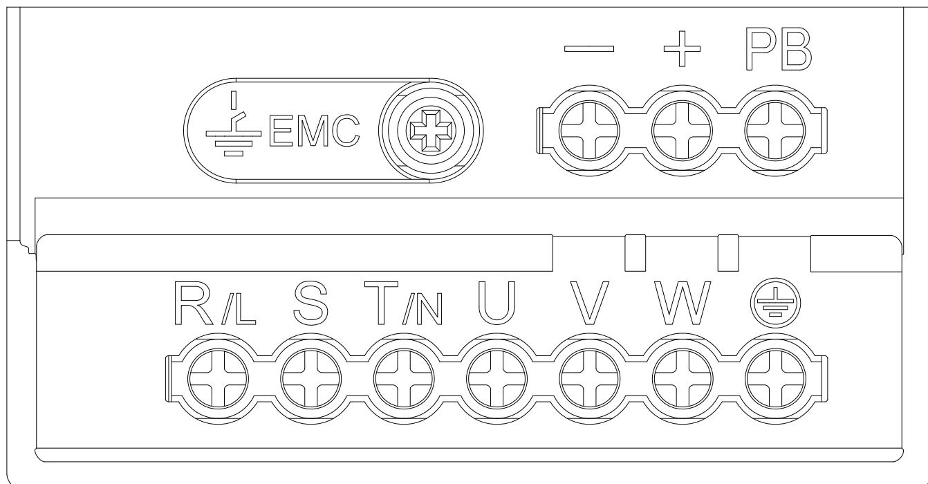
Рисунок 3.1-2 Расположение клемм
