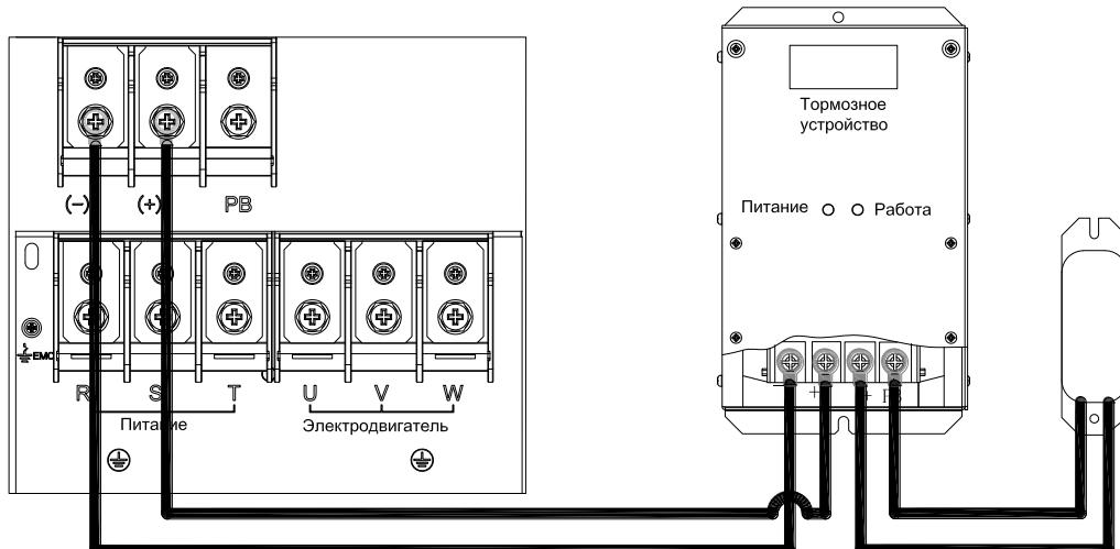
Рисунок 3.3-2 Подключение тормозного резистора для преобразователей частоты мощностью от 30кВт и выше через внешний тормозной модуль
