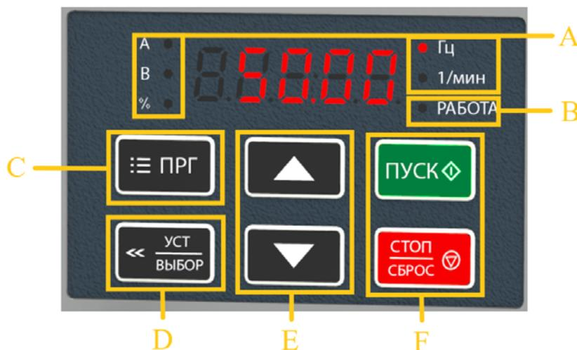
Панель управления преобразователя частоты
