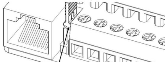
Для переключения логики цифровых входов PNP следует переставить перемычку возле клеммной колодки. Данный способ доступен для преобразователей частоты 7,5–22 кВт.
